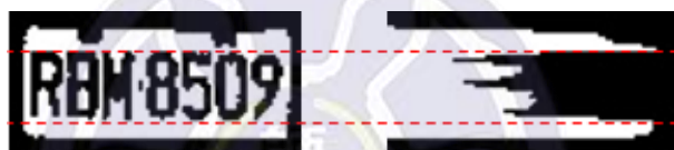
圖 4-7 水平投影切除上下多餘部分
