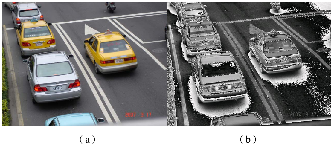
圖 3.5 原圖灰階影像經過 High Boost Filter (a) 原影像，(b) 影像增強後
