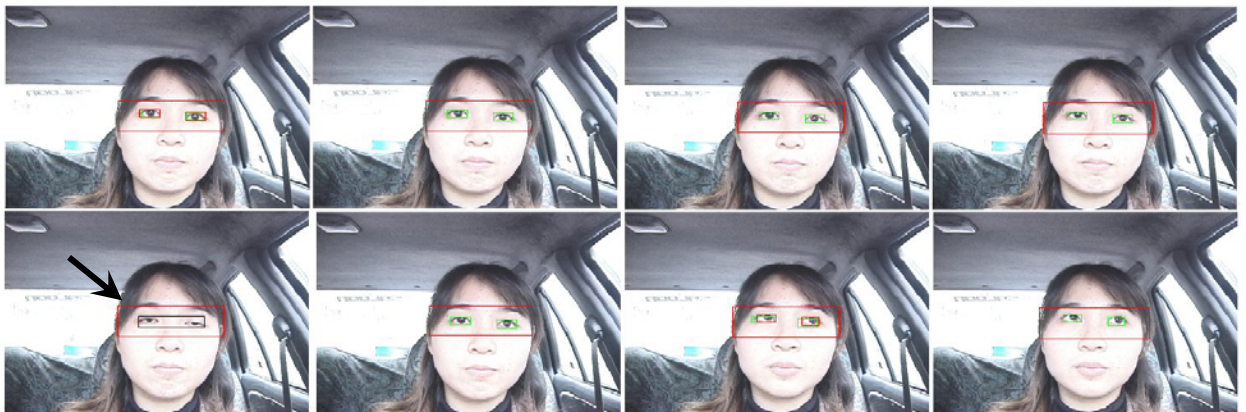
圖 2.9 連續影像中偵測眨眼的實驗結果，紅色方框代表使用眼睛偵測的方法偵測出眼睛，而綠色方框則是使用眼睛追蹤的方式找到眼睛，其中用箭頭表明偵測出閉眼狀態。
