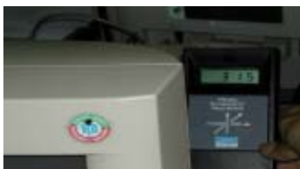
圖 3 電腦螢幕之電磁波測量—31.5mG
