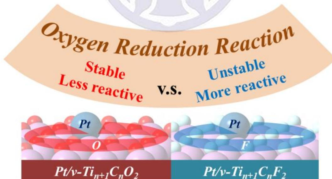
圖 5-8-1 ORR 於  $Pt/v-Ti_{n+1}C_nT_2$  ( $n = 1 \sim 3$ ,  $T = O$  or  $F$ ) 表面的反應性示意圖
