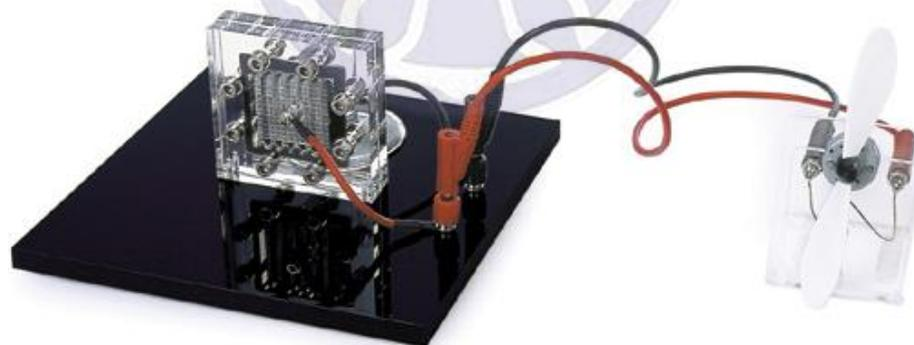
圖 3-1-1 直接甲醇燃料電池(DMFC)的外觀，輕巧的特性使其便於攜帶
