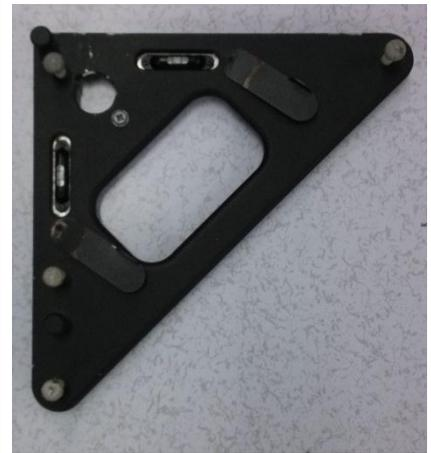
圖 6 L-Frame 校正架
