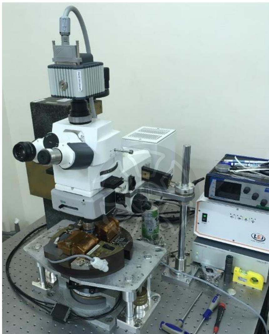
圖 25 磁光柯爾顯微鏡裝置圖
