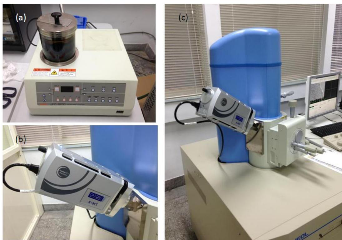
圖 2-3、SEM 加裝 EDX 儀器(a)蒸鍍機(b)加裝的 EDX(c)SEM 與 EDX 儀器
