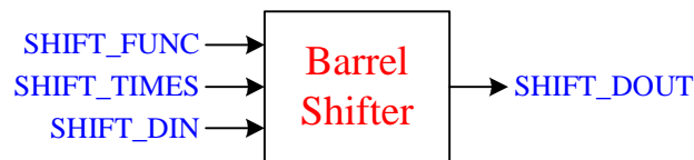
圖 B-9 Barrel Shifter 模組輸出入接腳規劃
