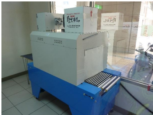
圖 4.2.8 封箱作業之機器 資料來源：研究者拍攝 (2015 年 4 月 3 日)
