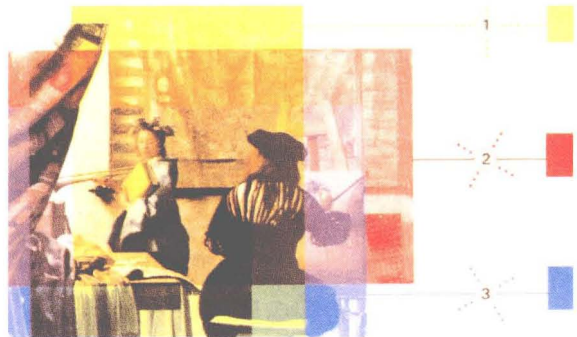
附圖三：利用原料色 (CMY) 將色光吸收。即用分色時未感光之原色油墨，先後重複套印於同一被印物質上，則因三原色重疊之多少不同，可印得與原稿相同之彩色複製品 (資料來源：賴一輝，民79)
