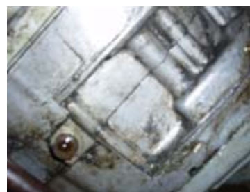
圖 4 齒輪箱底盤漏油
