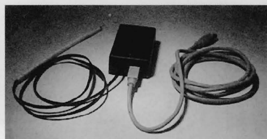
圖 4 可連接 PDA 的溫度探測針 (Temperature Probe) 資料來源： http://www.concord.org/probesight/new/template_section.htm
