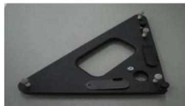
圖 3-4、ErgoCal L-Frame 校正架
