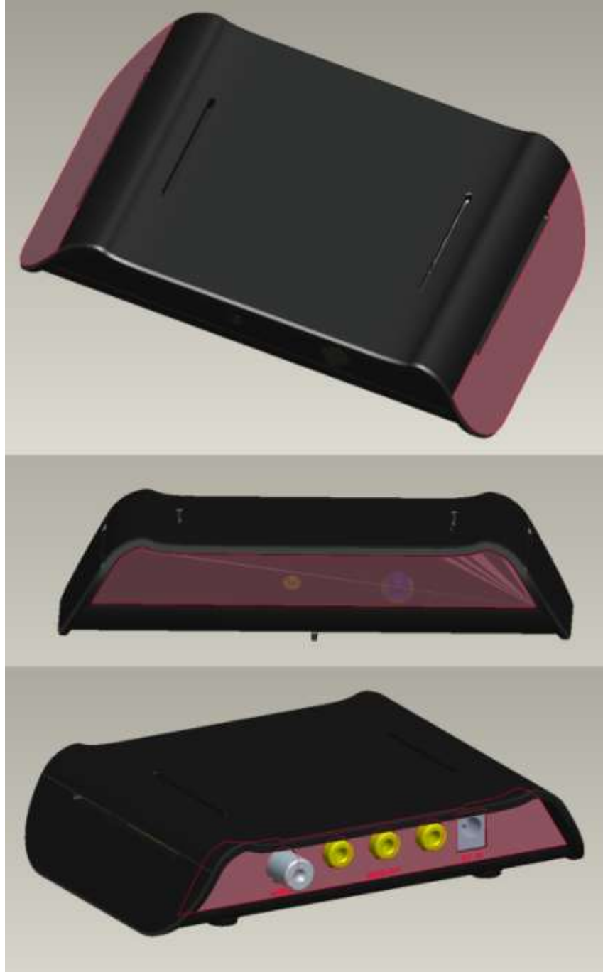
圖 4-19：創作(二) 3D 圖分模滑塊設計檢視
